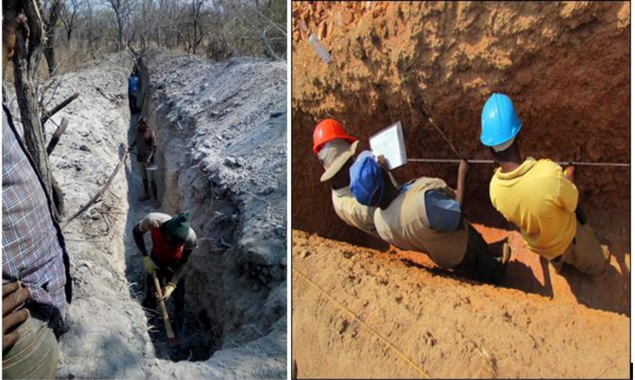
Picha Na.1: Utafiti wa kina –kuchimba Mitaro ( Trenches ) - kutafuta mwelekeo wa vein katika eneo la Itumbi
